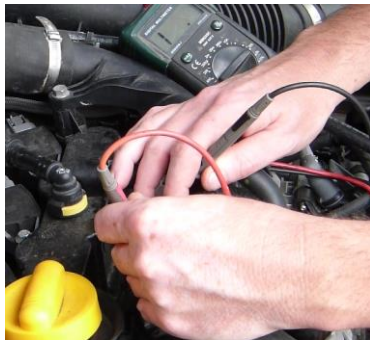
A l'aide d'un multimètre, tester la continuité entre les bornes de 2 connecteurs différents
